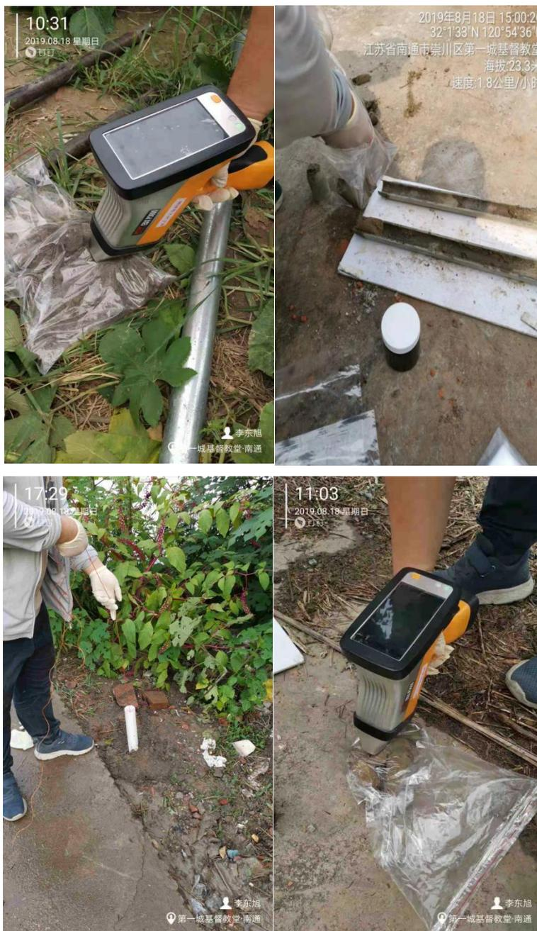
图 4-4 现场土壤及地下水样品采集、快检、建井、洗井照片
